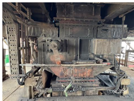
ภาพที่ 2-18 แผ่นปิดอัตโนมัติในห้องเตาเผา ป้องกันการกระจายของควัน
