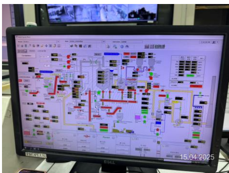
ภาพที่ 2-9 หน้าจอระบบ CCR แสดงค่าความแตกต่างของอุณหภูมิในตัวกลาง
